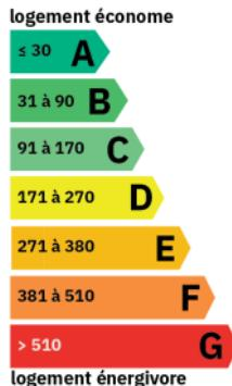
Emission de gaz à effet de serre en kgeq CO<sub>2</sub>/m<sup>2</sup>.an
